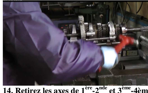
14. Retirez les axes de 1 ère -2 nde et 3 ème -4 ème ....
