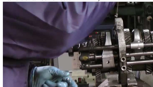
8. Avec la pointe aimantée retirez les 3 ressorts et les 3 billes de contrôles ....
