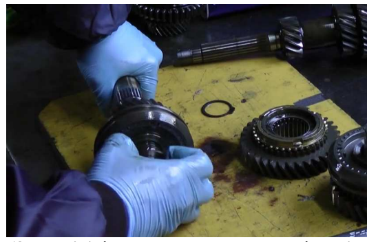
68. ...qui libère une rondelle de poussée, puis le manchon d'accouplement 3ème-4ème,....
