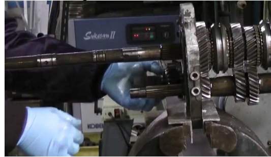
44. ....qu'on retire, ainsi que son roulement à aiguille..
