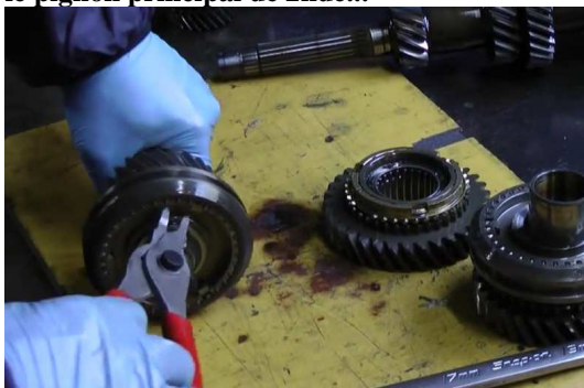
67. Sur l'avant de l'arbre primaire, on enlève le circlip....
