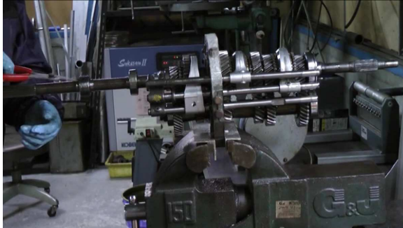
1. Enlevez le circlip du pignon de tachymètre de l'arrière de l'arbre principal...
