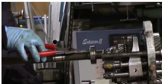
5. ...puis le circlip du palier arrière de l'arbre primaire.
