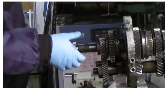
30. ....et enlever le gros écrou postérieur de l'arbre primaire.
