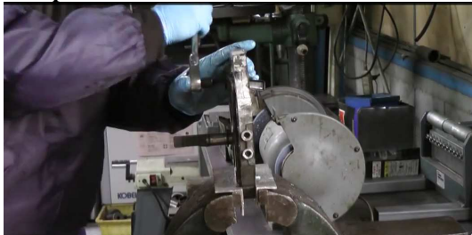
53. .... qui retiennent le mainteneur des deux roulements centraux.
