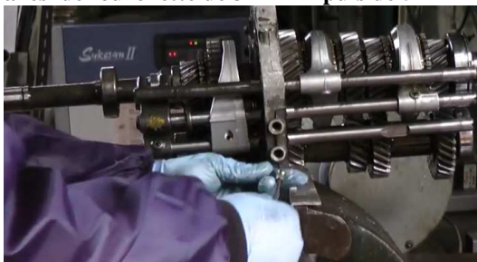
9. ... de leurs logement sur la platine d'adaptation.
