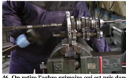
46. On retire l'arbre primaire qui est pris dans son palier central en frappant.....
