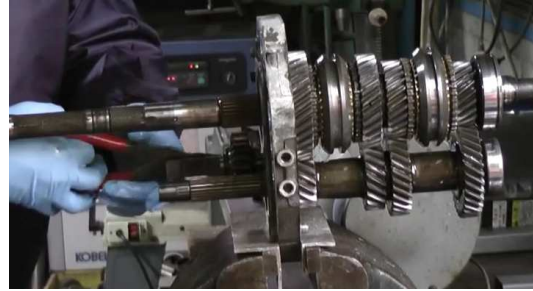
42. Sur l'arbre de renvoi de marche arrière, on retire le circlip.....
