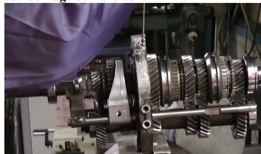
18. ...enlevez les 2 billes qui verrouillent ce même axe et l'axe de 5 ème -MA sous-jacent.
