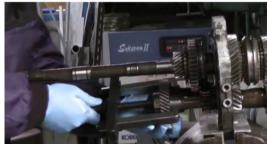
36. ... et en l'extrayant de l'arbre intermédiaire....
