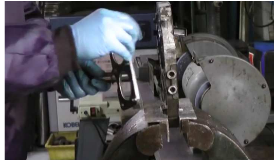
54. On retire l'arbre de renvoi de marche arrière et le mainteneur de roulement....
