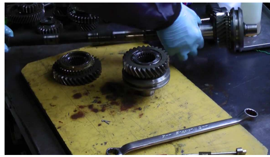
66. .... avec le moyeu de synchro de 1ère-2nde.
