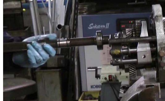
2....enlever le pignon du tachymètre en faisant attention de ne pas perdre la petite bille...
