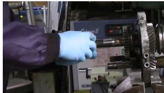
38. ....facilement de l'arbre primaire avec sa bague de synchro et le frein, ....
