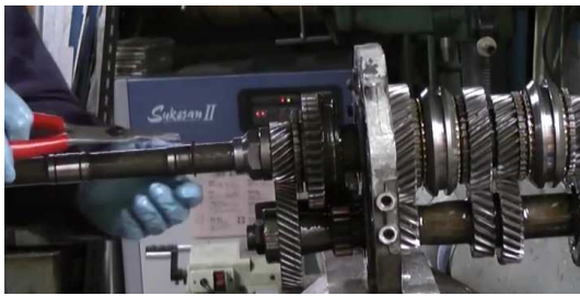
25. Puis enlève le deuxième circlip du palier postérieur de l'arbre primaire.
