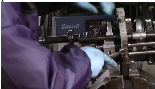
7. Dévissez le bouchon de la bille de contrôle (des axes de fourchette de 3 ème -4 ème puis de 5 ème -MA)
