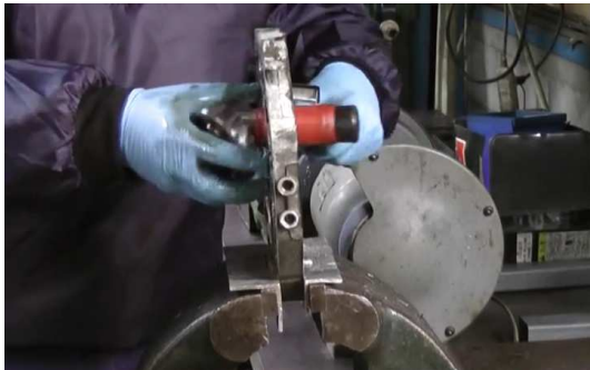
55. .... ce qui libère facilement le roulement central de l'arbre secondaire....
