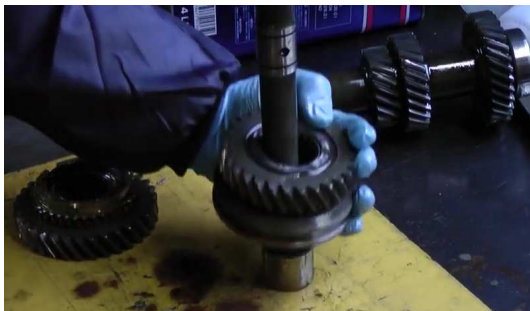
65. ....le manchon d'accouplement 1ère-2nde , et le pignon principal de 2nde...
