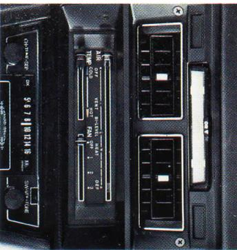
Radio montée sur la console (équipement standard).
