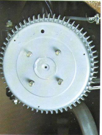
Freins arrière assurés par tambours à ailettes de refroidissement.
