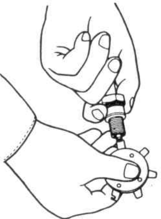
Fig. ET-13 Vérification de l'écartement des bougies
